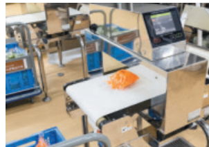
製造ラインに設置した金属探知機による検査
