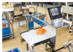
製造ラインの金属探知機による検査
