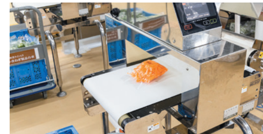
製造ラインに設置した金属探知機による検査の様子
