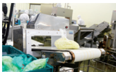
製造ラインに設置した 金属探知機による検査 の様子
