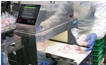
金属探知機による検査の様子
