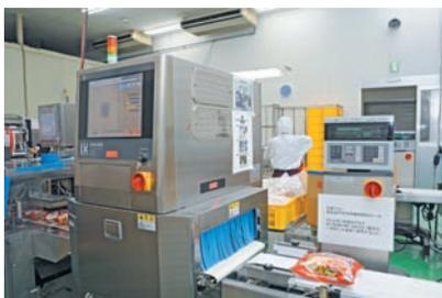
X線検査装置による梱包検査
