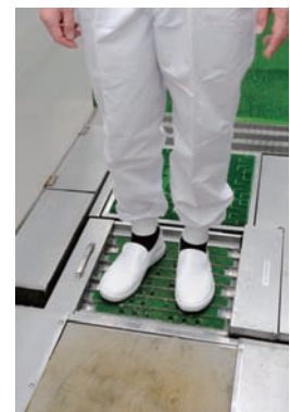
靴底を作業後に洗浄して保管。清潔な状態を保ちます
