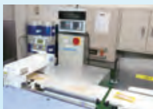
全生産ラインに備わる金属探知機
