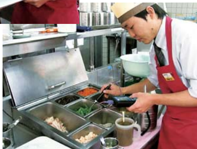
● 冷機器の温度検査
